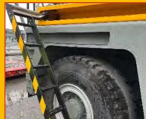
Die hydraulische ausfahrbare Treppe ermöglicht den bequemen und vor allem sicheren Zugang zur Fahrerkabine. (Option)
