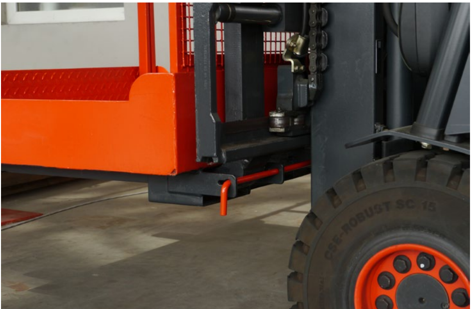
Abb. 2 Formschlüssige Befestigung der Arbeitsbühne
