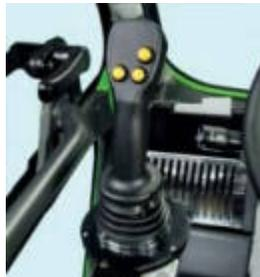
Die zweite Armlehne mit Joystick (optional) führt die Ausladevorgänge des Teleskoparms, die Neigung des Anbaurahmens und die Betätigung der Anbaugeräte aus. Die kombinierte Betätigung mit dem Basis-Joystick (rechtes Bild) beschleunigt die Vorgänge.
