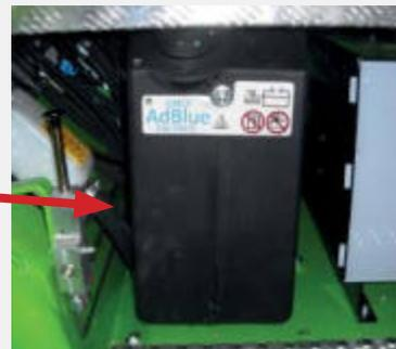
Der Harnstofftank (A) fasst 25 Liter, die für zwei Dieseltankfüllungen ausreichend sind.
