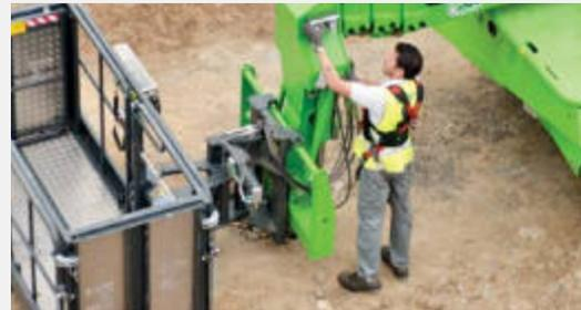
Rohre, Elektrokabel und zusätzliche Hydraulikanschlüsse befinden sich im Inneren des Teleskoparms, sodass maximaler Schutz gewährleistet ist.
