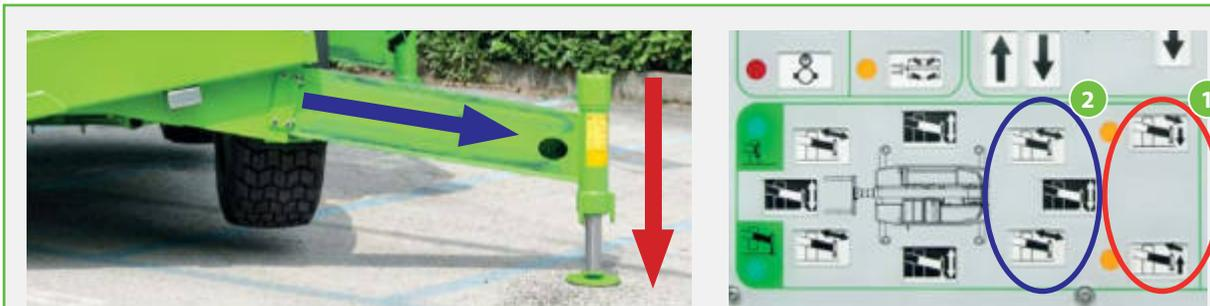
Vier unabhängige Abstützungen: Selbst die Abstützung mit vollkommen eingefahrenen Stabilisatoren ist möglich. Die Abstützung erfolgt in zwei Phasen: 1. Seitliches Ausfahren des Arms (blauer Pfeil) 2. Senken des Kolbens des Hebebocks (roter Pfeil)
