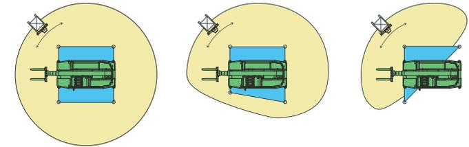
Die Arme der Abstützungen können je nach Arbeitsbereich ausgefahren werden. Das Merlin-System steuert daraufhin automatisch und in Echtzeit das dynamische Gleichgewicht der Last.
