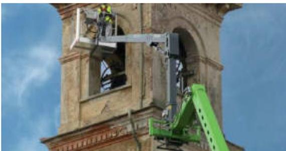
Durch das Schwenken des Arbeitsbühnen trägerarms des Systems Space ist auch der Zugang zu sonst schwer erreichbaren Punkten möglich.
