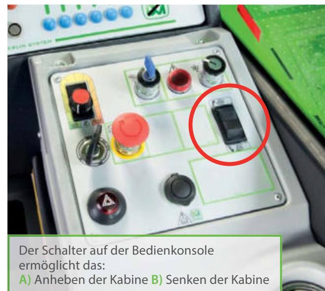
Der Schalter auf der Bedienkonsole ermöglicht das:
