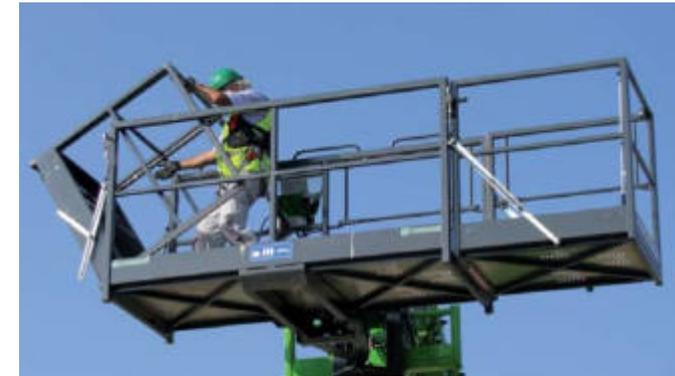
Bei einigen Hebebühnen von Merlo ist die Nutzbreite veränderlich über ein praktisches und patentiertes Erweiterungssystem, das auch in der Höhe betätigt werden kann.
