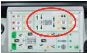
Die Steuerung der Stützzylinder erfolgt so (vorne unabhängig, hinten paarweise), dass ein Niveuausgleich des Rahmens erreicht wird.
