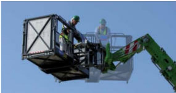
Die bei vielen Merlo Hebebühnen mögliche hydraulische Drehung um die vertikale Achse gestattet das Arbeiten auch bei einer im festen Winkel aufgestellten Maschine.
