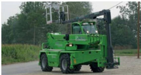
Das System Space kann mit der Roto Telekopmaschine direkt auf der Straße transportiert werden.
