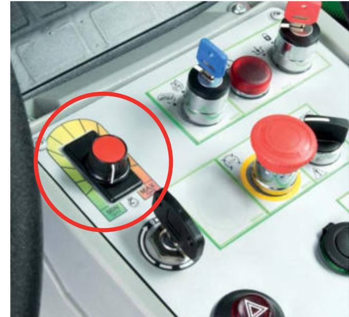
Potenziometer zur manuellen Einstellung der Drehzahl des Dieselmotors
