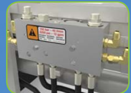
Leicht zugängliches Ventil mit integrierter Druckbegrenzung
