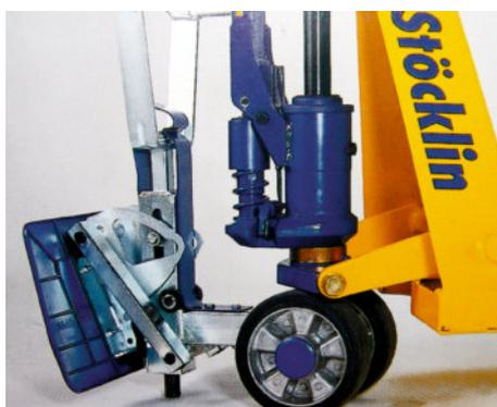
Drehbarer Mittelbolzen (Oberfläche gehärtet).
