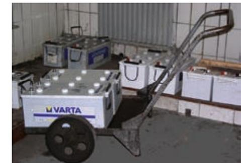
Bild 7-8: Geeignete Transporteinrichtung für Batterien
