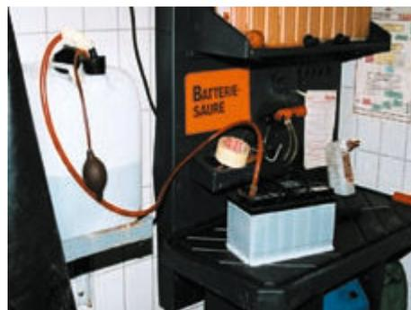
Bild 7-5: Säure-Nachfüllplatz einer Batterieladestation
