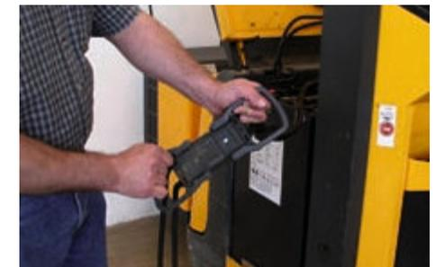
Bild 7-3: Kontaktierung einer eingebauten Flurförderzeugbatterie mit dem Ladegerät mittels berührungssicherer Steckvorrichtung
