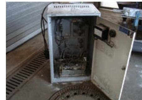
Bild 7-7: Durch Brandschaden zerstörtes Batterieladegerät
