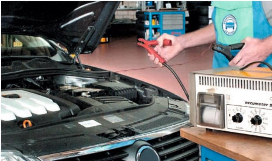
Bild 4-1: Vorbereitung zur Ladung der Batterie in einem Personenkraftwagen
