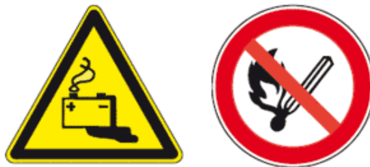
Abbildung 4: Erforderliche Warn- und Verbotssymbole für eine Batterieladestation
