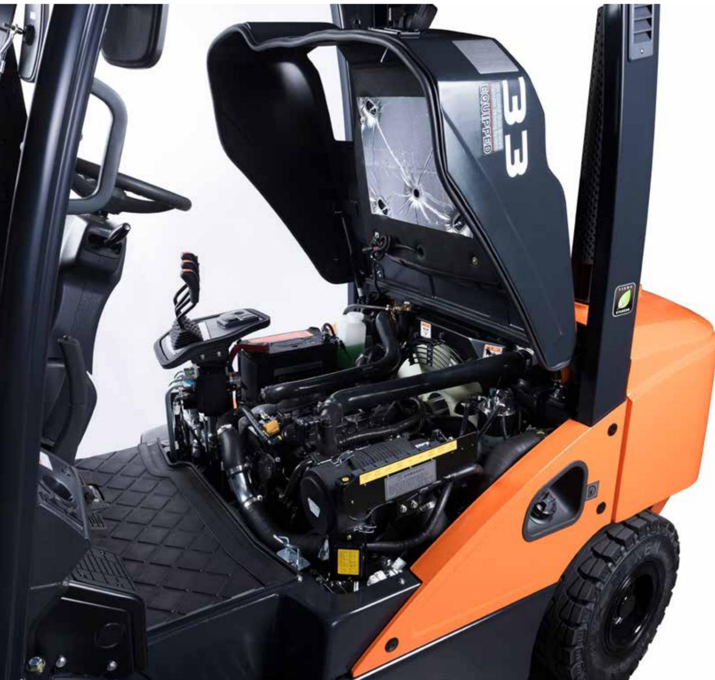
Unsere leistungsstarken Diesel- und Treibgasmotoren entsprechen den geltenden Umweltbestimmungen. Sie bieten ein hohes Drehmoment bei niedriger Motorgeschwindigkeit, hilfreich bei Beladungen an Rampen oder schnellen Hubgeschwindigkeiten.
