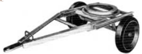
Achse ganz durchlenkbar Axle with 360° steering angle
