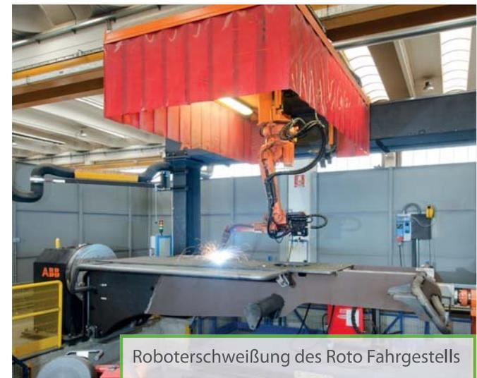
Roboterschweißung des Roto Fahrgestells
