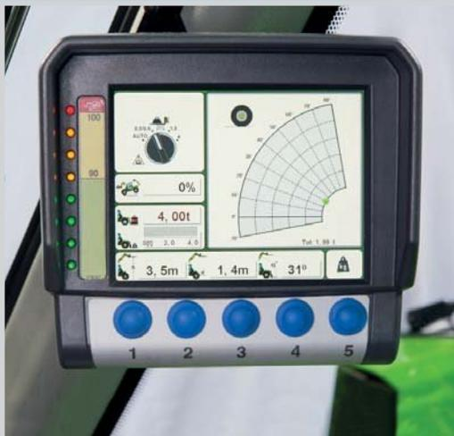
Das M CDC-System (Dynamische Lastkontrolle) überprüft konstant die Längsstabilität der Maschine in Abhängigkeit von den dynamischen Arbeitsparametern (Art der verwendeten Ausrüstung, gehobenes Gewicht, Arbeitsausladung und -höhe).
