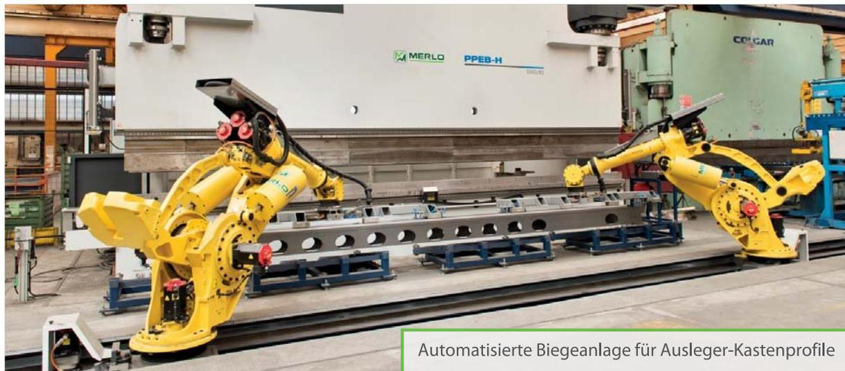
Automatisierte Biegeanlage für Ausleger-Kastenprofile
