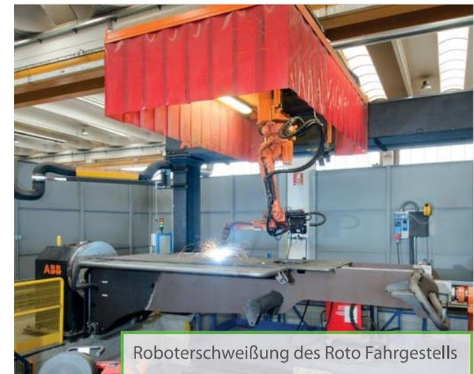
Roboterschweißung des Roto Fahrgestells
