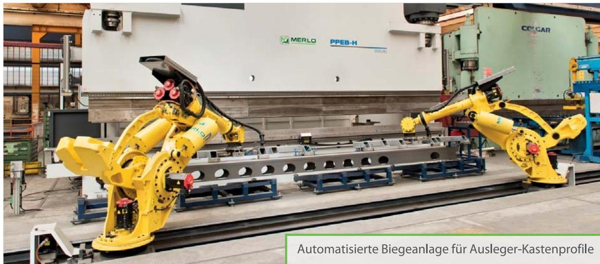
Automatisierte Biegeanlage für Ausleger-Kastenprofile
