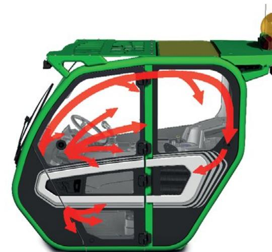
Der Luftstrom wird gleichmäßig in der Kabine verteilt und erreicht alle Bereiche auf optimale Weise.
