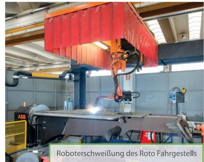
Roboterschweißung des Roto Fahrgestells
