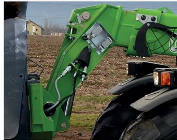
Rohre, Elektrokabel und zusätzliche Hydraulikleitungen sind im Inneren des Teleskoparms untergebracht
