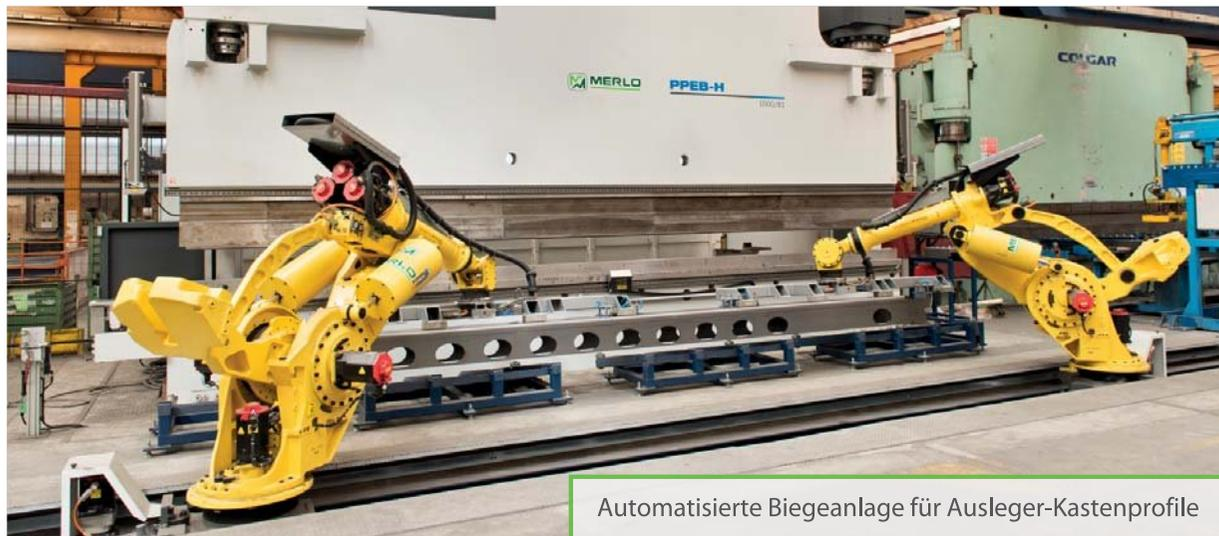
Automatisierte Biegeanlage für Ausleger-Kastenprofile
