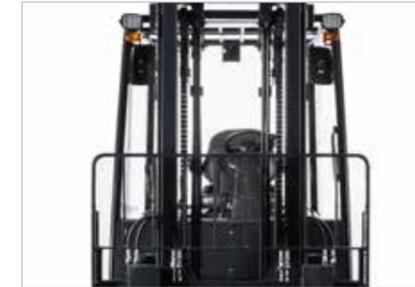
Die übersichtlich angeordneten Hydraulikschläuche und Ketten bieten eine gute Durchsicht nach vorn.
