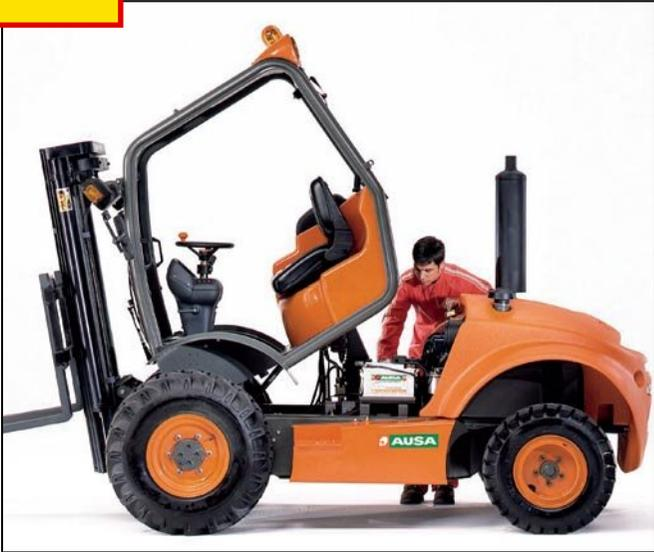
Kippbare Kabine welche eine extrem einfache Wartung ermöglicht
