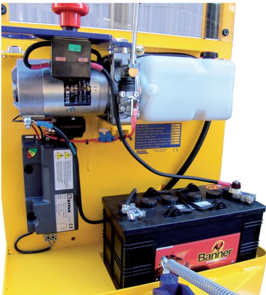
Eingebautes Ladegerät, Batterie 12 V,
